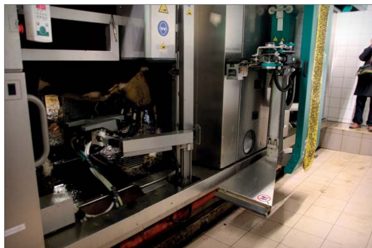
V rekonstruované stáji v Milasíně dojí dvouboxový robot od výrobce GEA
